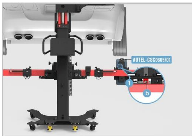
図6-34 レーダーキャリブレーションボックス(右)を移動します
