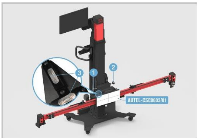
図6 -70 NVキャリブレーターの水準器の気泡を中央に合わせる
