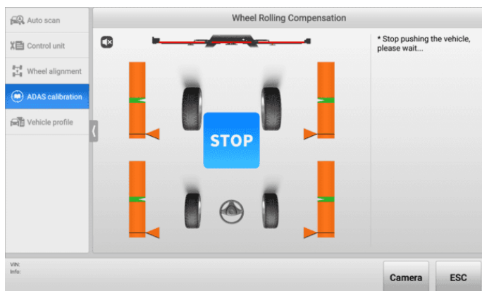
図6 -42 ホイールローリング補正 3
