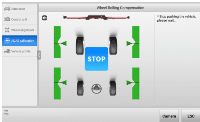
図6 -96 ホイールローリング補正 4
