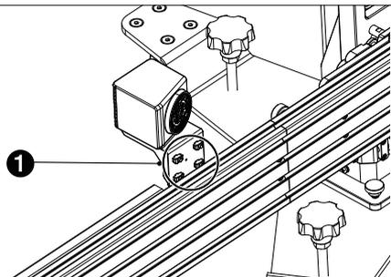
4個のM6 Tハンマーナット(1)を六角穴付ネジ(M6×14)を使用して中央カメラに水平に向けて取り付けます。次に、クロスバーを締め付けるためのノブから約 50 mm (1.97 インチ) の位置にあるクロスバーの 1 番目と 2 番目のスライド スロットにそれらを押し込みます。
