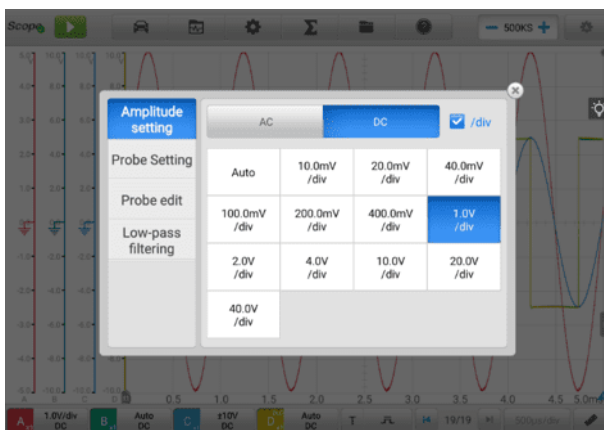
図7 -42 振幅設定画面 (DC1.0V/div)
